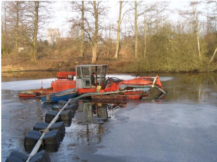
Der Schwimmbagger saugt den Schlamm auf und pumpt ihn in das Auffangbecken.<sup>8</sup>
