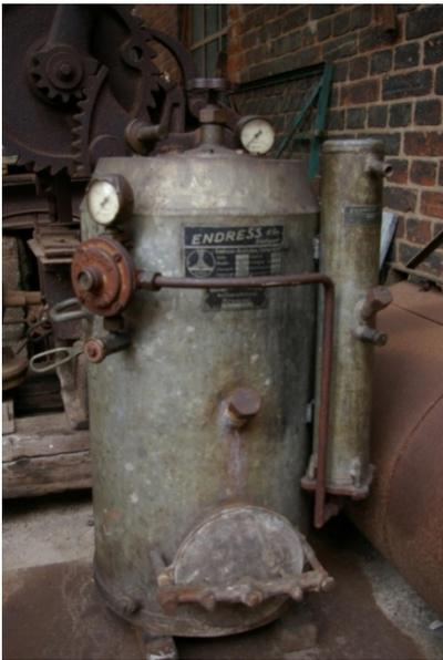
Ein transportabler **Acetylen-Entwickler**: Damit konnte man vor Ort sein Acetylen-Gas zum Schweißen erzeugen. Er wurde mit Karbid (Calciumcarbid) und Wasser gefüllt. Eine chemische Reaktion ließ daraus gebrannten Kalk und Acetylen entstehen. Mit Acetylen und Sauerstoff ließ sich dann auf der Baustelle die nötige Hitze zum Schweißen erzeugen.
