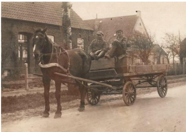
Ackerwagen mit einem oder 2 Pferden in Sudweyhe. Das obere Fahrzeug war gut zum Aufladen von Milchkannen, Säcken usw. geeignet, das untere mehr zu Transport von Feldfrüchten, Saatgut, Heu und Stroh etc. Beide Modelle hatten Holzläder, das obere hatte eine Federung, da untere nicht.
