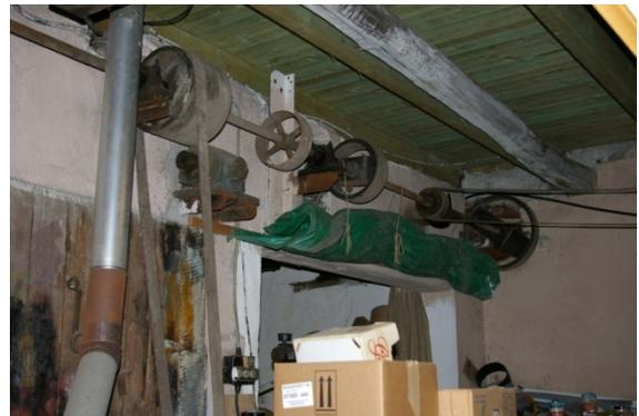
bestimmtem Winkel zum Riemen standen, lief der Riemen nicht vom Rad. Mit Wachs wurde die Reibungskraft erhöht, um so ein „Durchdrehen“ der Räder zu verhindern.
