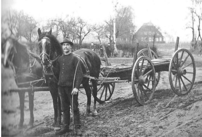
Ein Ackerwagen mit 2 PS in Lahausen um 1913. Die beiden Seitenteile liegen übereinander auf dem Gestell. Nebeneinander gelegt verbreitern sie die Ladefläche. Aufgestellt an den 4 Haltepfosten dienen sie zum Transport z.B. von Futter oder Mehlsäcken.<sup>11</sup>
